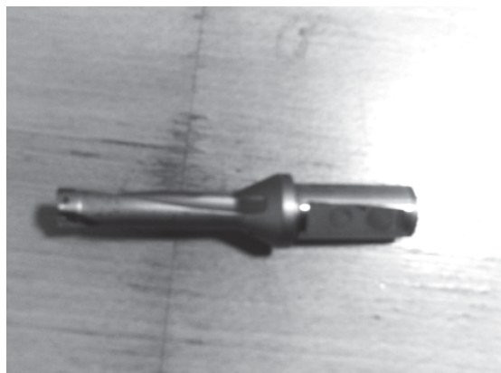
Рисунок 2 – Свердло зі швидкозмінними пластинами Джерело: [5, 6, 7]
