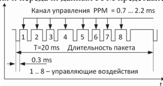
Рисунок 3 – Метод кодирования PPM
