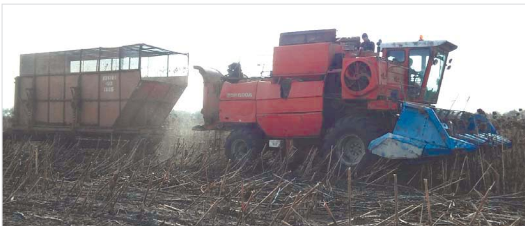
Рисунок 1 – Збиральний агрегат в складі комбайна «Дон-1500А» та модернізованого зразка причіпного копнувача
