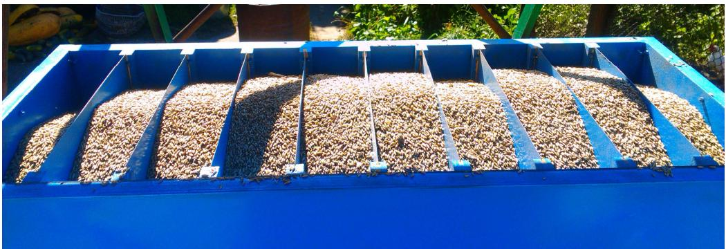
Рисунок 5 – Приймальний пристрій з розподіленою по коміркам сумішшю
