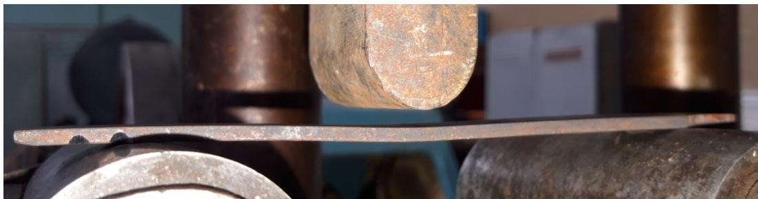
Рисунок 3 – Вихідне положення зразків дисків сошника після зняття навантаження, температура відпускання – 380° С
