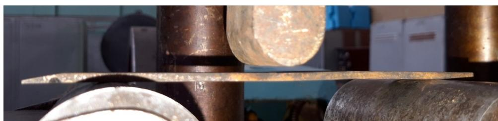
Рисунок 2 – Вихідне положення зразків зі сталі марки 30MnB5 після зняття навантаження, температура відпускання – 180° С
