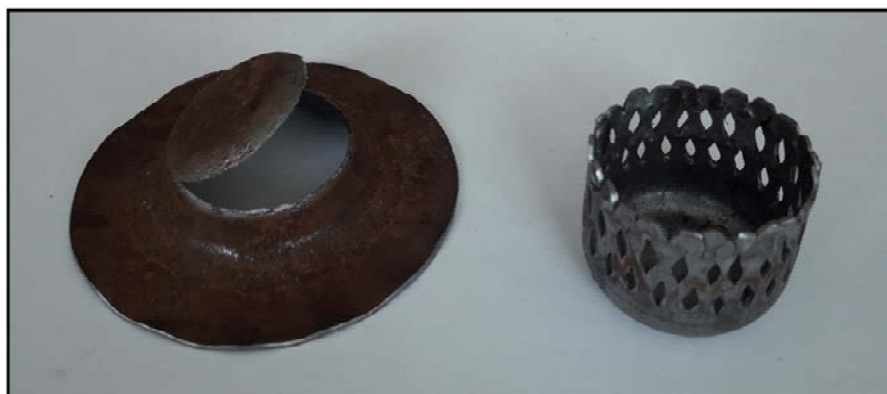
Рисунок 19 – Зразки, що отримані в рівних умовах при коефіцієнті витягування m = 0,44 із суцільної (а) та не суцільної (б) заготовок
