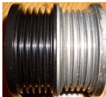
Рисунок 2 – Вигляд анодованого та не анодованого шківів колінвала
