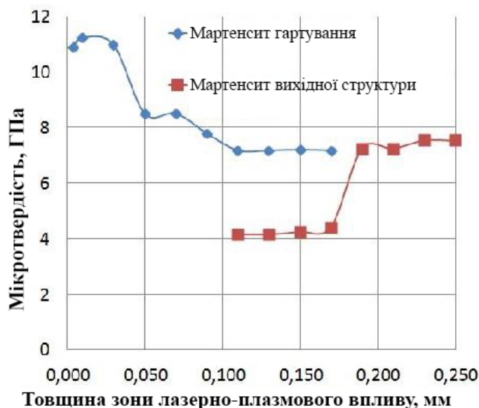
Рисунок 4 – Розподіл мікротвердості структурних складових за глибиною зони лазерно-плазмового впливу у сталі з вихідною структурою мартенситу
