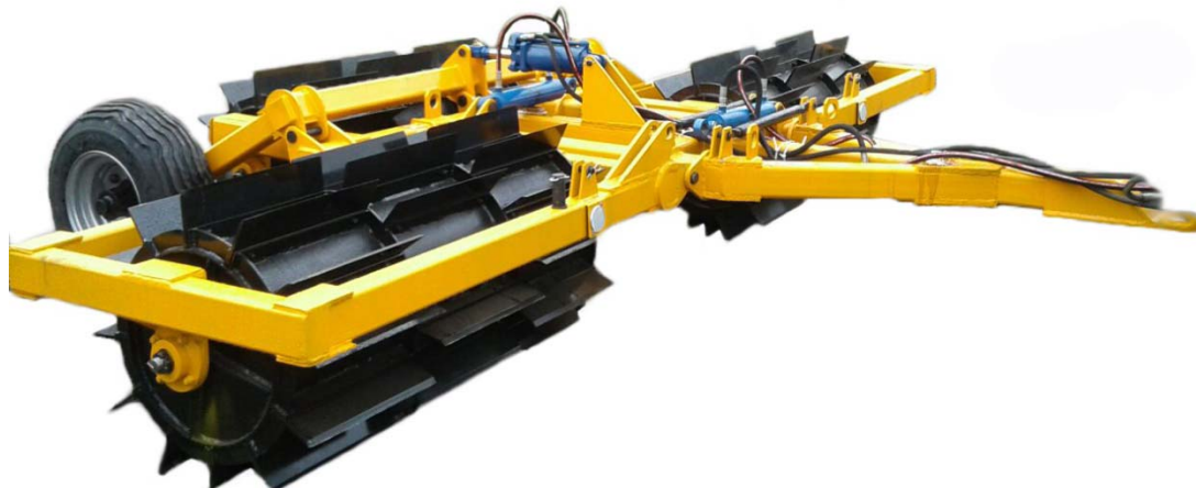
Рисунок 2 – Загальний вигляд експериментального котка-подрібнювача рослинних решток ПК-4,5
