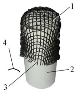
1 – ковпачок із квадратної сітчастої вихідної заготовки; 2 – опрання із паперу; 3 – місце, з якого випав короткий дріт; 4 – короткий дріт, що випав Рисунок 13 – Ковпачок з дротом, що випав
