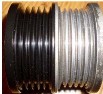
Рисунок 2 – Вигляд анодованого та не анодованого шків колінвалу
