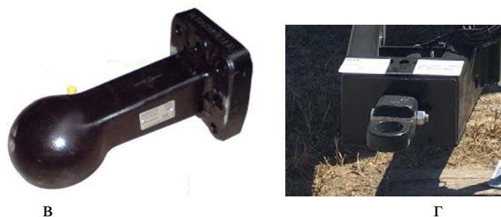
а – Тип А; б – Тип В; в – Тип С з фланцем; г – Тип D зі змінною плитою та фрагментом диска (Kinze 851)
