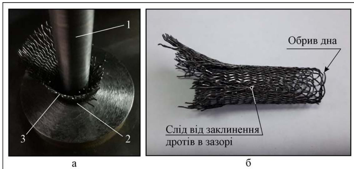
а – момент заклинення дротів в зазорі; б – деталь після витягування; 1 – пуансон; 2 – матриця; 3 – заготовка в процесі витягування
