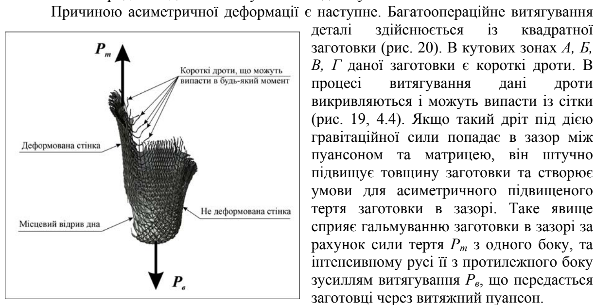
Рисунок 19 – Приклад асиметричної деформації деталі при витягуванні із металевої сітки Джерело: розроблено авторами
