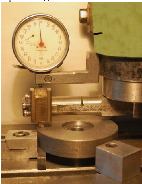
Рисунок 2 – Робоча зона пристрою для нанесення антифрикційного покриття
