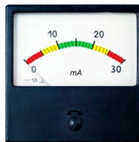
Рисунок 4 – Конструкційна побудова шкали міліамперметра М42300 (розфарбовано авторами)
