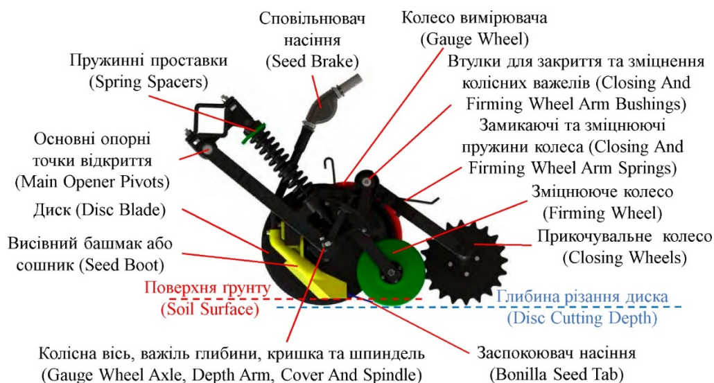
Рисунок 1 – Конструкція висівної секції пневматичної сівалки John Deere
