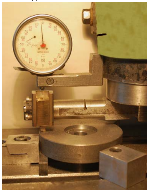
Рисунок 2 – Робоча зона пристрою для нанесення антифрикційного покриття
