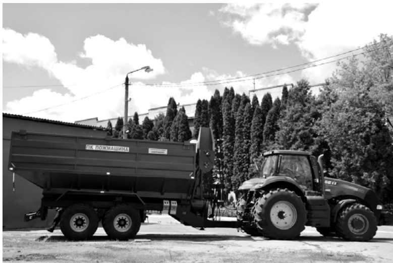
Рисунок 4 – Бункер для накопичення та перевантажування зерна БНП-30
