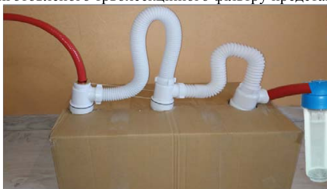
Рисунок 6 – Зовнішній вигляд виготовленого трьохсекційного фільтра Джерело: розроблено авторами
