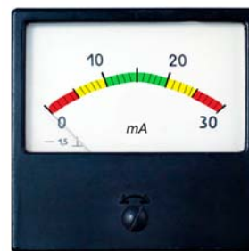
Рисунок 4 – Конструкційна побудова шкали міліамперметра M42300 (розфарбовано авторами)
