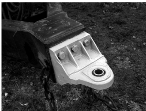
Рисунок 9 – Причіпний пристрій, вдосконалений ЦНТУ та встановлений на бункер-накопичувач перевантажувальний БНП-30ПП
