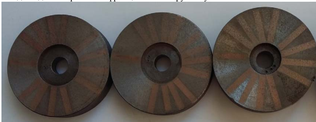
Рисунок 3 – Досліджувані зразки з антифрикційним покриттям Джерело: розроблено авторами
