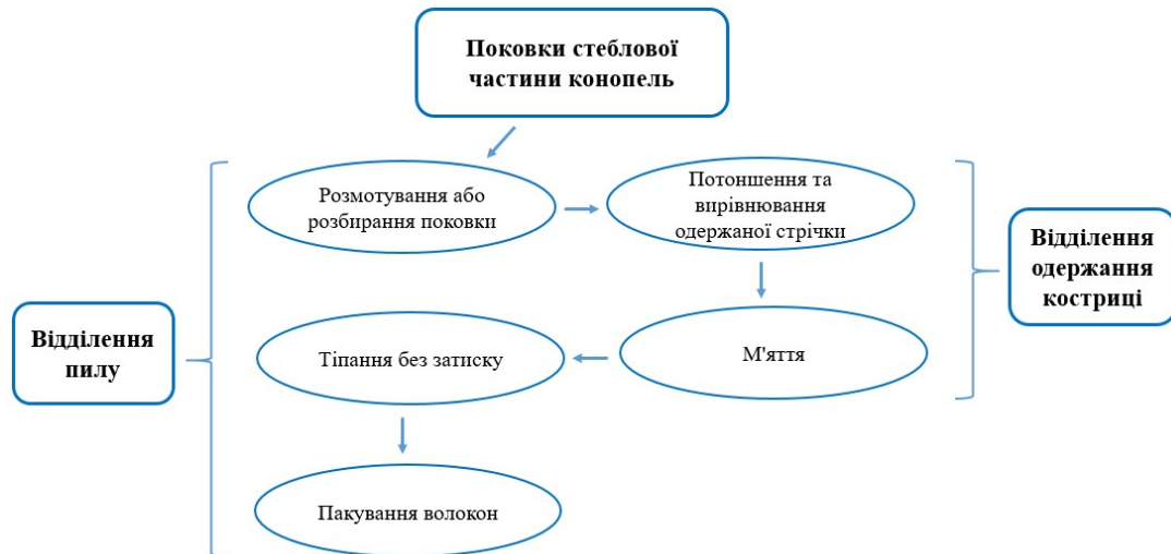
Рисунок 6 – Схематичне зображення технології одержання однотипного волокна
