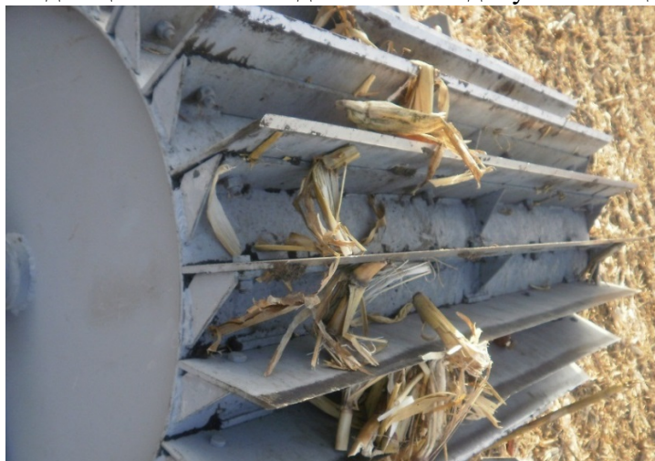
Рисунок 1 – Приклад накопичення рослинних решток між ножами барабана
