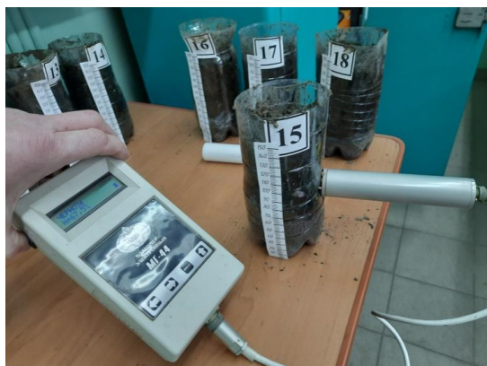
Рисунок 3 – Фото вимірювання вологості середнього шару досліджуваного зразка
