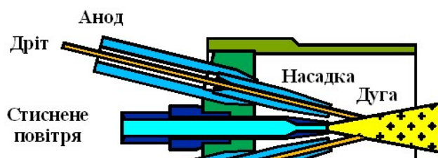
Рисунок 1 – Принципова схема розпилювання краплин розплаву порошкового дроту та формування електродугових покриттів на їх основі
