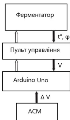
Рисунок 6 – Автоматична система керування ферментатором
