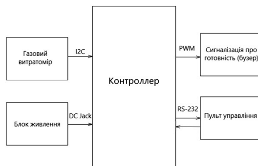
Рисунок 8 – Функціональна схема автоматичного контролю ферментацією
