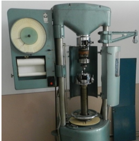
Рисунок 3 – Загальний вигляд стенду, на якому розміщений пальцевий запобіжний пристрій Джерело: розроблено авторами
