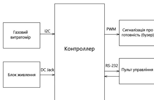
Рисунок 8 – Функціональна схема автоматичного контролю ферментацією
