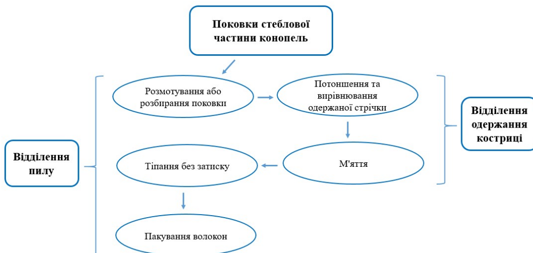
Рисунок 6 – Схематичне зображення технології одержання однотипного волокна
