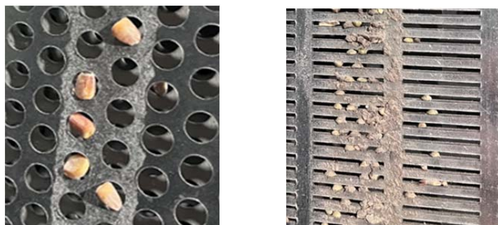
Рисунок 10 – Приклади наявності неочищених зон на ППП
