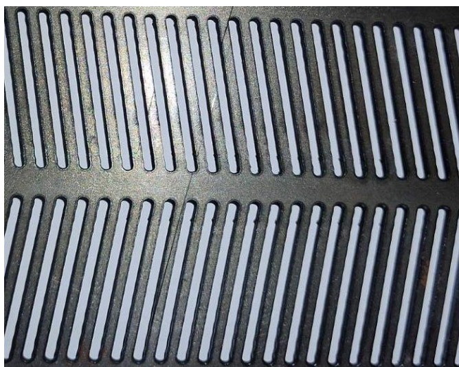
Рисунок 4 – Фрагмент решітного полотна із зигзагоподібним розташуванням отворів Джерело: розроблено авторами
