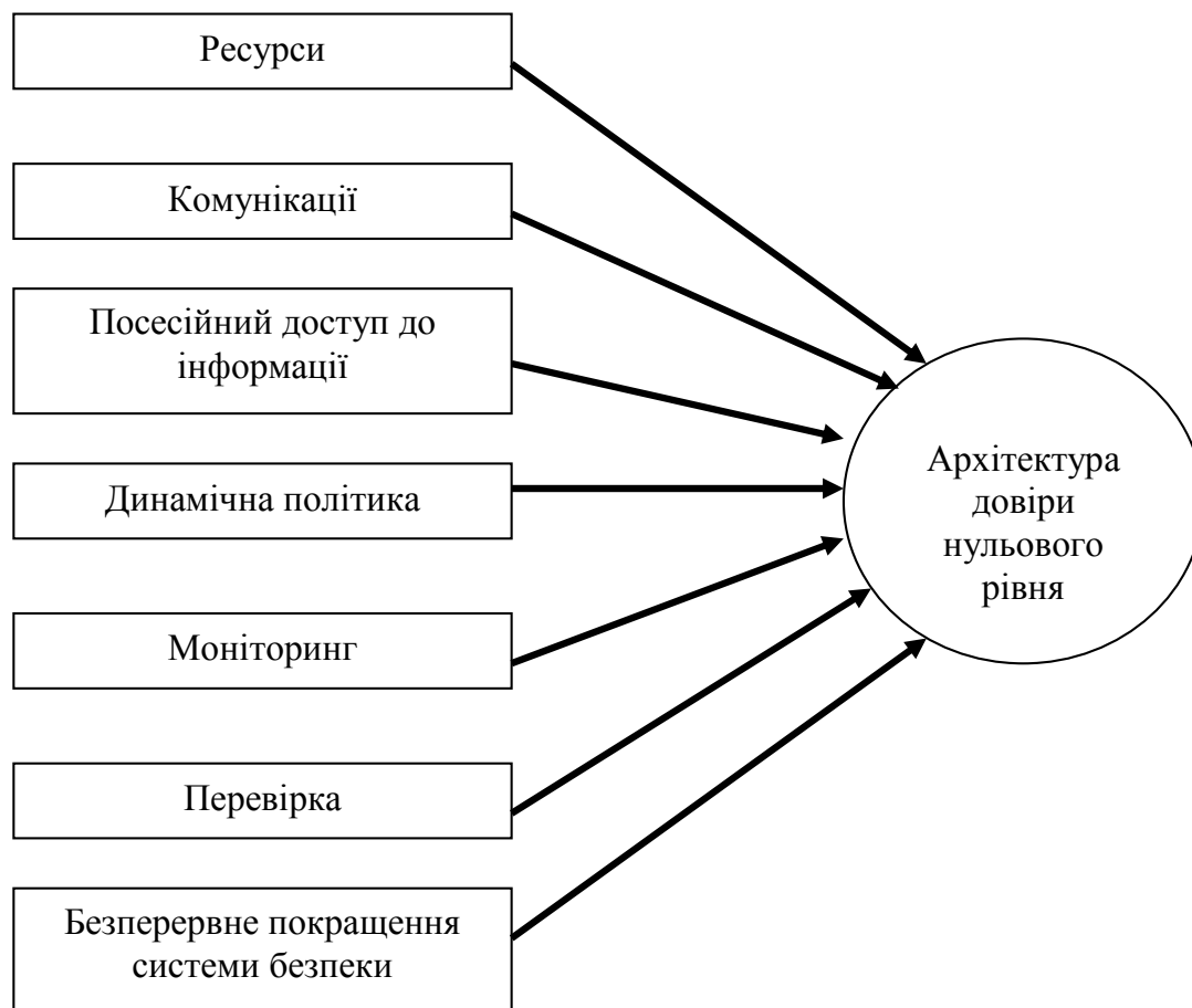
Рисунок 3 – Принципи проектування архітектури нульової довіри
