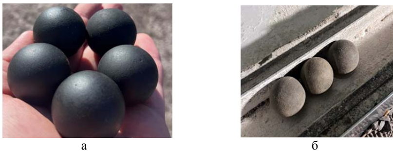
Рисунок 5 – Загальний вигляд чистих (а) та забруднених (б) кулькових очисників Джерело: розроблено авторами
