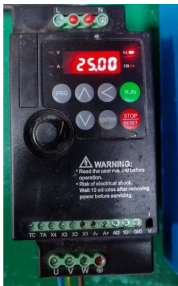
Рисунок 7 – Регулювання і контроль частоти коливань
