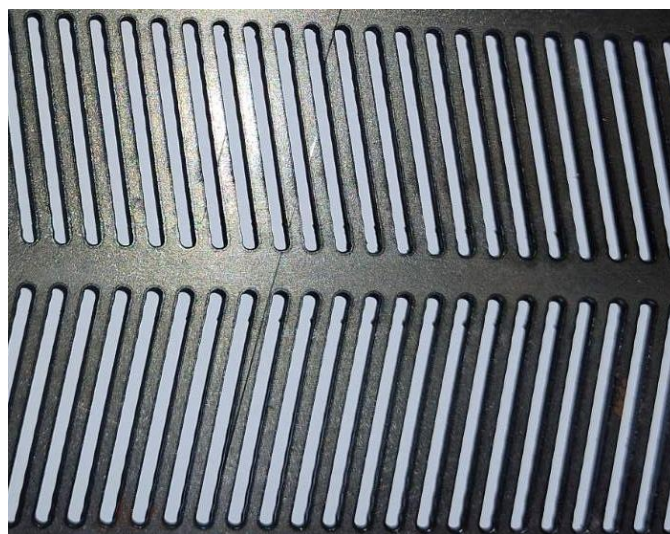
Рисунок 4 – Фрагмент решітного полотна із зигзагоподібним розташуванням отворів Джерело: розроблено авторами
