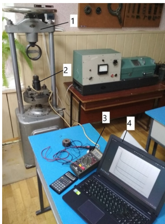
1 – ручний гвинтовий прес ДМ-30М; 2 – пристосування ДМ-22М; 3 – мультиметр; 4 – комп'ютер
