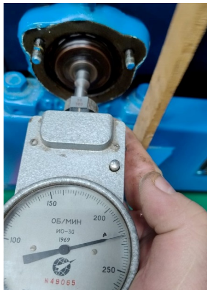
Рисунок 7 – Регулювання і контроль частоти коливань
