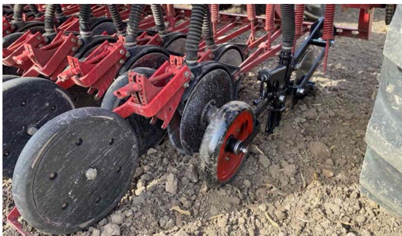
Рисунок 2 – Порівнювані робочі органи в складі сівалки СЗ-3,6 «Астра» Джерело: розроблено авторами із використанням [7]
